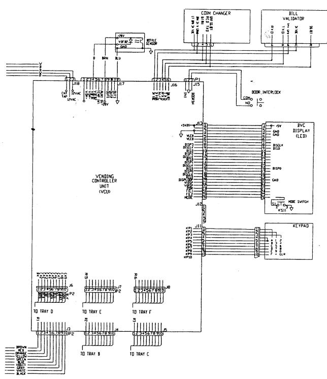
ECC SYSTEM SCHEMATIC (RIGHT SIDE; MDB) SAMPLE
